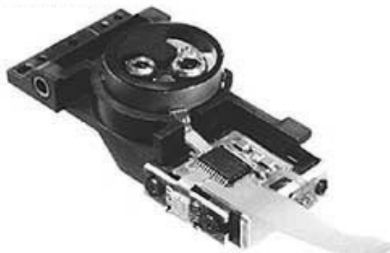
Takto vyzerá laserová hlava DVD prehrávača s dvoma šošovkami
